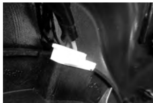
Connecteur du woofer monté sur haut-parleur IS 165TOY
