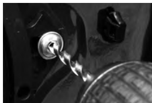
Dérivage du haut-parleur d'origine (x3 rivets/HP)
